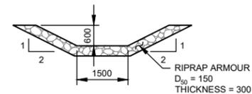
**TYPICAL SECTION SOUTH COLLECTION CHANNEL 0+297 TO 0+521 SCALE C**
