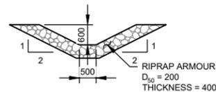
**TYPICAL SECTION SOUTH COLLECTION CHANNEL 0+183 TO 0+267 SCALE C**
